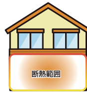
(B) 1階層だけの断熱工事
