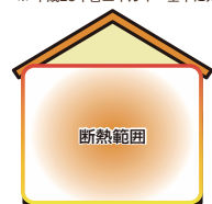
(C) 1棟丸ごとの断熱工事
