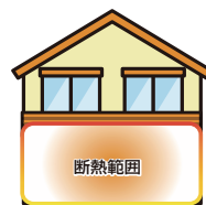
(B) 1階層だけの断熱工事
