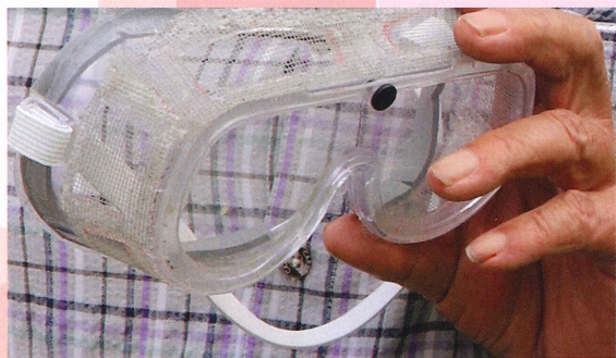
最新作は、側面に網戸の網を張って改良した草刈り用の防塵ゴーグル。網を張ることで、汗による曇りや結露を防ぎます。
